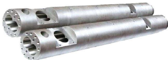
Âmbito de aplicação: WPC PVC, WPC PE, folha molecular super alta, fivela de cálcio alto 1/2, tubo de cálcio alto 50-400, 50-300 PP, PE, ABS, PVC, matéria-prima, pelotização, tubo, perfil, folha etc.
